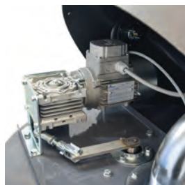
006 - Scuotifiltro elettrico automatico
