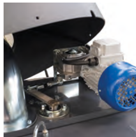
006 - Scuotifiltro elettrico automatico
