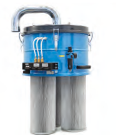
008 - Filtro primario a cartuccia con pulizia automatica mediante getto d'aria in controcorrente
